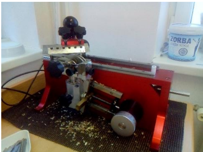
Obr. P1: Technická údržba Lab-Microtome – výměna žiletky a čištění.
